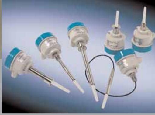
El Pointek® CLS 200 es la solución ideal para la detección de nivel en condiciones extremas (físicas o químicas). Es un sensor capacitivo de dos hilos muy resistente a los productos químicos y apto para el control de bombas y la detección de interfaces, sólidos, líquidos, lechadas y espuma.
